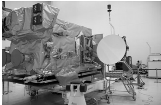
[그림 3] 천리안 1호 위성 통신탑재체 조립 형상 및 안테나 전개 형상
